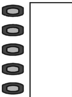
Les **touches de fonction** à côté de l'étiquette de marquage sont des touches programmables, par ex. pour la numérotation cible ou pour l'utilisation des fonctions du téléphone. La DEL indique le statut de la fonction.
