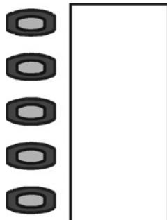
Die **Funktionstasten** neben dem Beschriftungsschild sind programmierbare Tasten z. B. für Zielwahl oder die Bedienung von Telefonfunktionen. Die LED zeigt den Status der Funktion an.
