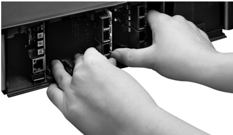
Abb. 8: Modul herausziehen (COMpact 5000R)
