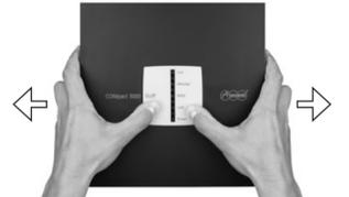
2. Ziehen Sie die Abdeckhaube an beiden Seiten etwas vom Gehäuse weg, um die Rastverriegelung aufzuheben.
