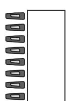
Die **Funktionstasten** neben dem Beschriftungsschild sind programmierbare Tasten z. B. für Zielwahl oder die Bedienung von Telefonfunktionen. Mit jeder Taste stehen Ihnen zwei Ebenen für die Belegung mit Funktionen zur Verfügung.
