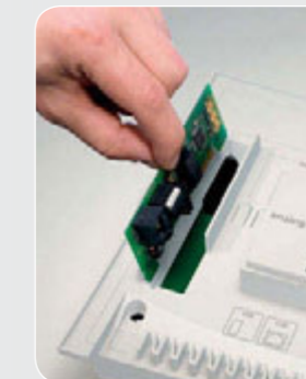
Erweiterungsmodul für interne Teilnehmer (analog oder S 0 oder U 0 ) oder einen ISDN-Amtport (s. Seite 13).
