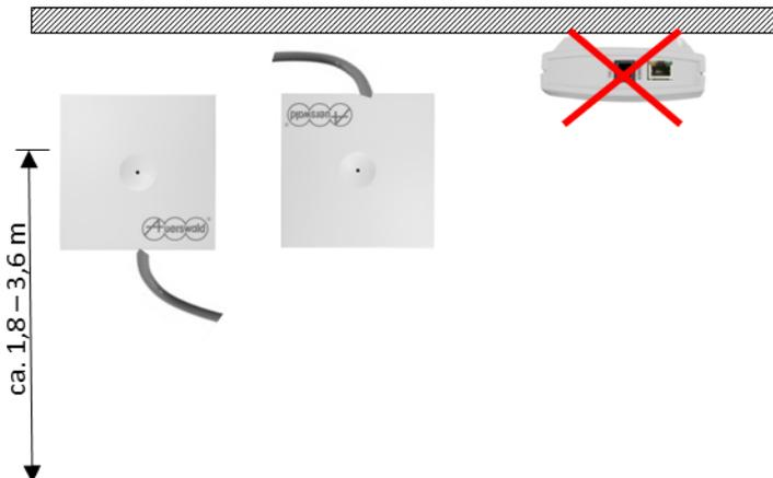
**Abbildung 11: Montagerichtung der Basisstationen**
