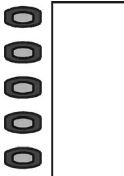
Die **Funktionstasten** neben dem Beschriftungsschild sind frei programmierbare Tasten z. B. für Zielwahl oder die Bedienung von Telefonfunktionen. Mit jeder Taste stehen Ihnen zwei Ebenen für die Belegung mit Funktionen zur Verfügung.
