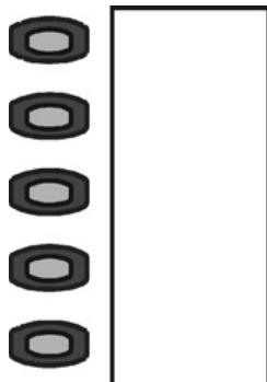
Las **teclas de función** situadas junto a las etiquetas rotulables son teclas que se pueden programar libremente por ejemplo para la marcación rápida o el manejo de las funciones del teléfono. Con cada tecla dispone de dos niveles para la asignación de funciones.
